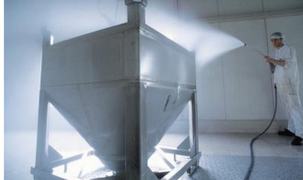
In der Container-Waschstation werden die Mehrwegbehälter gereinigt und können so direkt wieder in der Produktion eingesetzt werden.
