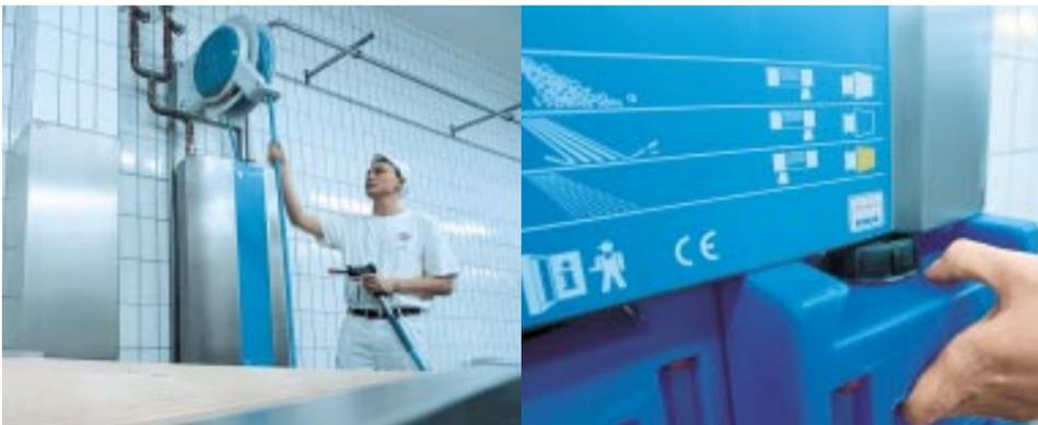
Bei dem Reinigungsprozess der Pizzalinien erkennt das System automatisch die vorgeschaltete Düse und stellt Waschmittelzusammensetzung und Wasserdruck optimal ein. Zudem ist durch das Zustecksystem eine Verwechslung der Behälter mit Reinigungsmittel ausgeschlossen.
