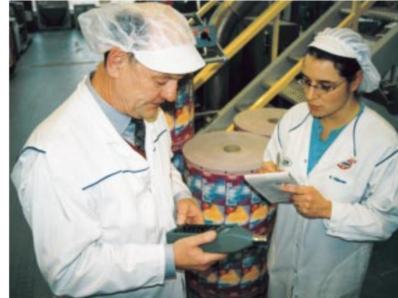
In regelmäßigen Abständen werden zum Schutz der Mitarbeiter Lärmmessungen in den Produktionsbereichen durchgeführt.
